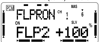
Flap en cours de réglage Débattement des servos (FLP1 ou FLP2) Gamme: -120% à +120% Valeur usine: +100%
