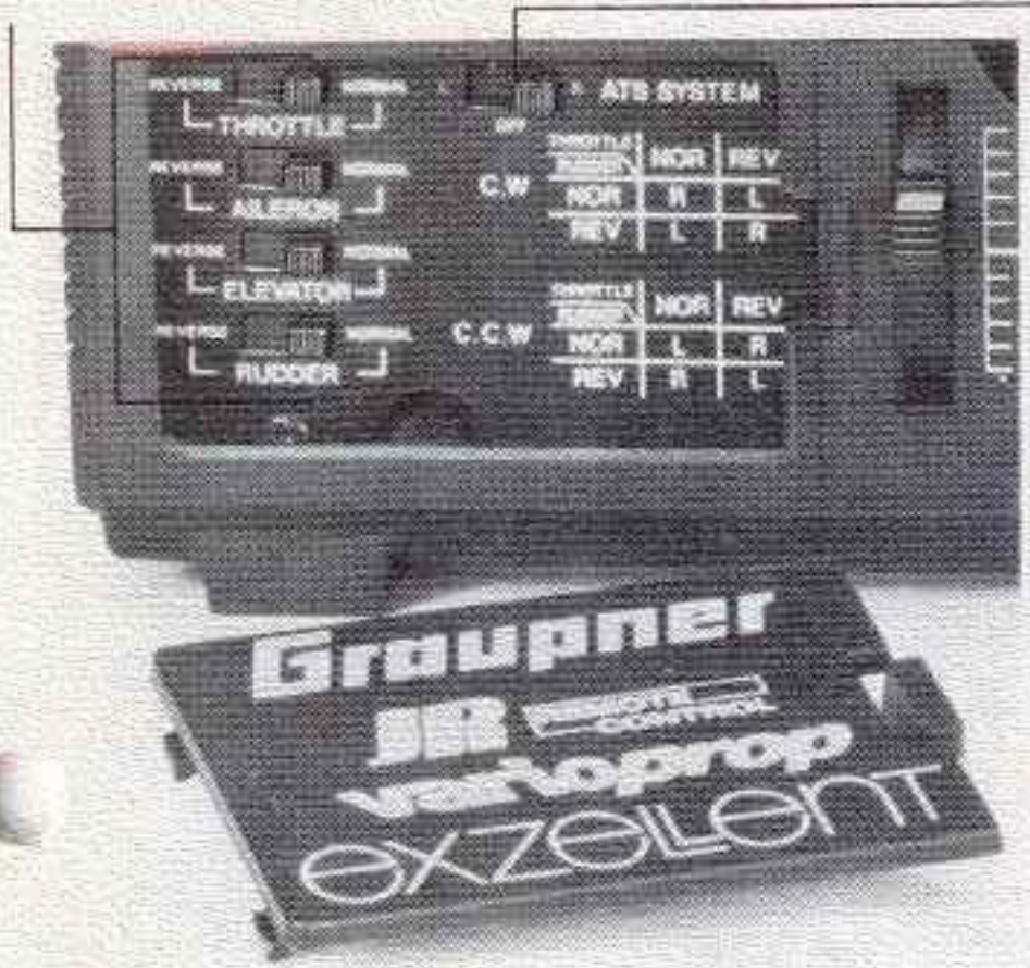
Système Anti-Torque ATS (Compensation statique et dynamique de l'anticouple)
